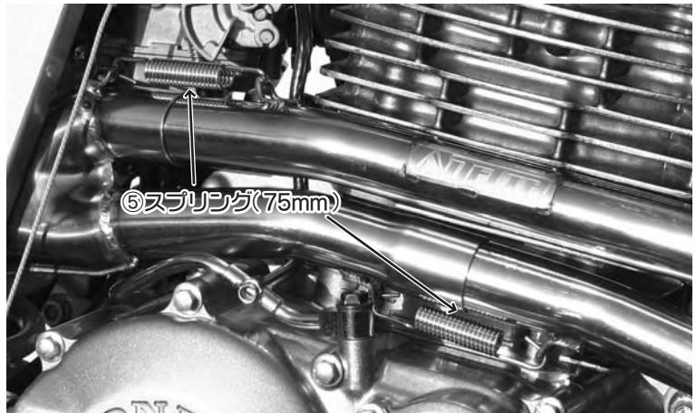
7. サイレンサー側を全て仮締めの状態にして下さい。
