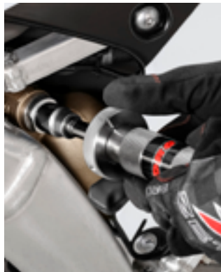
▲先端にマイナスドライバーを配置。これにより、低速側 COMP アジャスターも調整可能。
